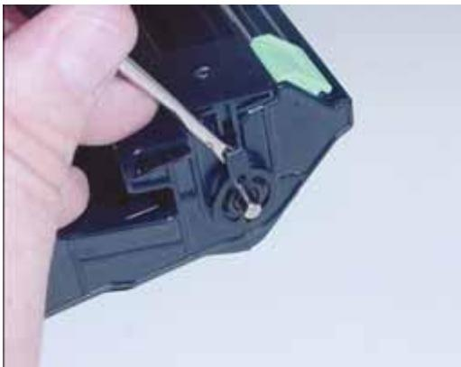
**4. Снимите стабилизатор оси.**
