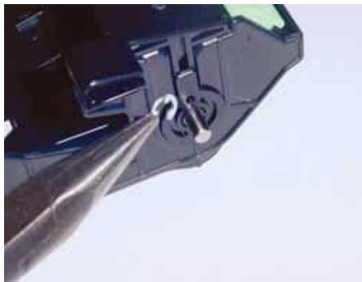
**3. Используя небольшую плоскую отвёртку, подковырните стабилизатор оси.**
