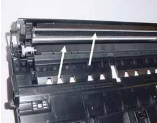
8. Извлеките барабан и шестерню из крепления барабана.
