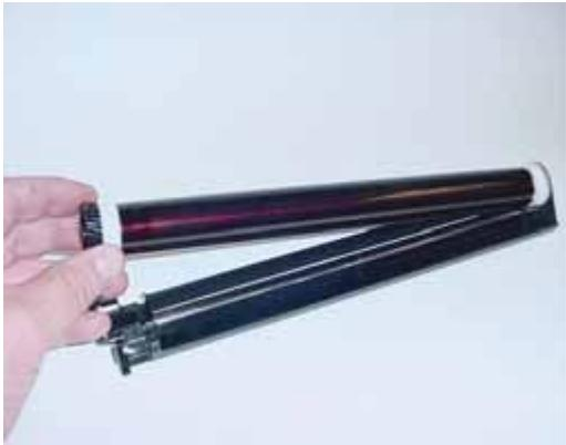
9. Прочистите решётку коронирования сжатым воздухом. Используйте ватный тампон с 99% изопропиловым спиртом, чтобы удалить тонер с провода коронирования.
