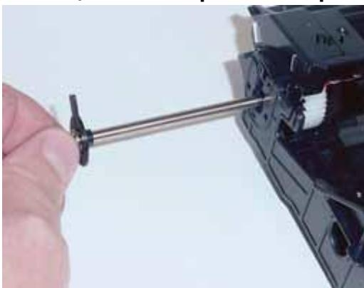
**6. Поднимите вверх крепление барабана, чтобы отделить его от картриджа.**
