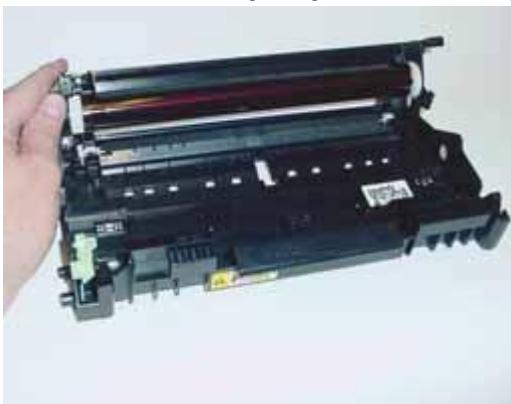
**7. Прочистите вал передачи и фетр очищающего вала сжатым воздухом.**
