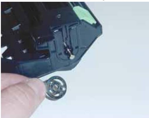
**5. Вытащите ось барабана с противоположной стороны картриджа.**
